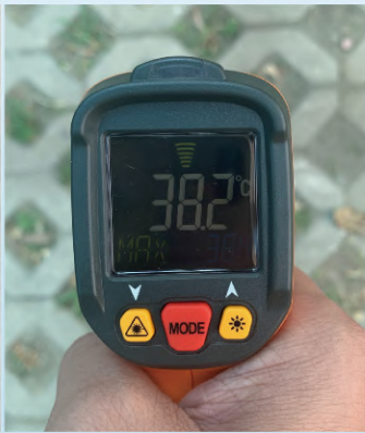
② 透明隔熱壓克力下的植草磚溫度，實測為 38.2 度。
