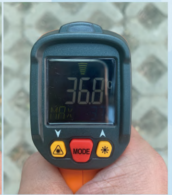
③ 霧面隔熱壓克力下的植草磚溫度，實測為 36.8 度。
